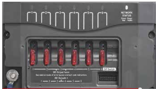
CZone Output Module Fuses
