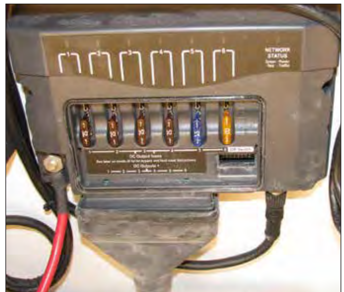
CZone Module & Color Coded Fuses
